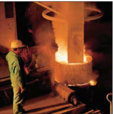
Krystalizace grafitu do tvaru kuliček se vyvolá modifikací hořčíkem do základní vysoce kvalitní litiny.
